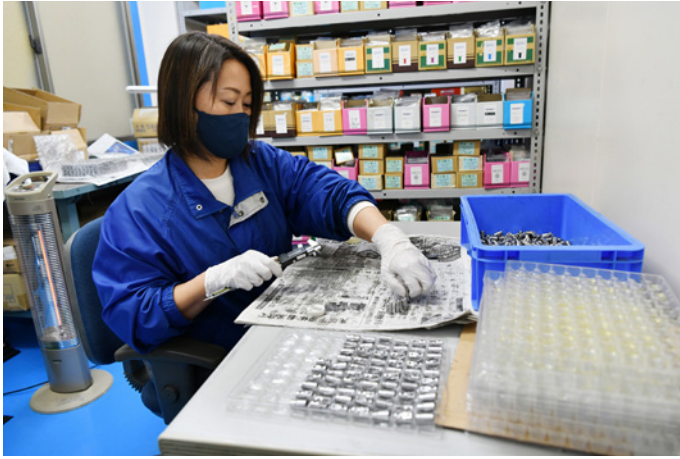
検品はねじ生産の「最後の砦」。1点1点を人の目と手で細部までチェックする。
